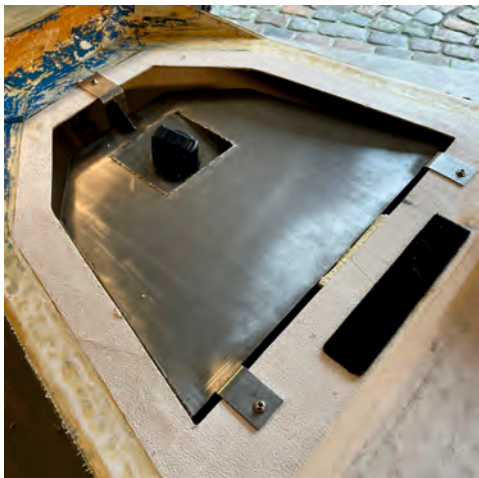
der Kraftstofftank konnte fest im vorderen Bereich eingebaut werden
