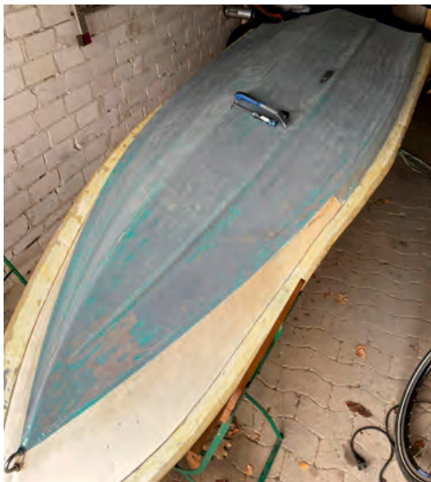
Unter anderem musste der Unterwasseranstrich komplett entfernt und
