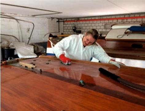
*Erst wird der alte Lack angeschliffen ...*
