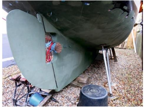
*Das Unterwasserschiff ist 2x mit 2-K Primer gestrichen, nun fehlt noch das Antifouling*
