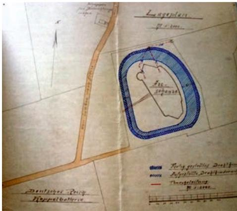
Die Auschanze war als Erdwerk angelegt. Als Schutzraum für die Soldaten waren 12 Wellblechunterstände vorhanden. An den Schuterpunkten gab es zwei Postenstände, die mit doppelten Eisenblechwänden und Kiesfüll-
